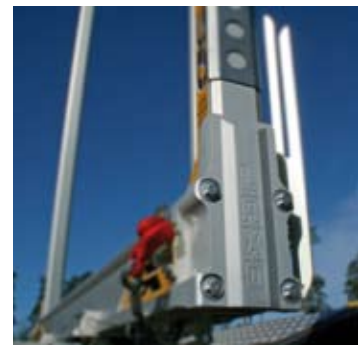
Stöttorna kan enkelt lossas och vändas. Eller bytas om de har skadats.
