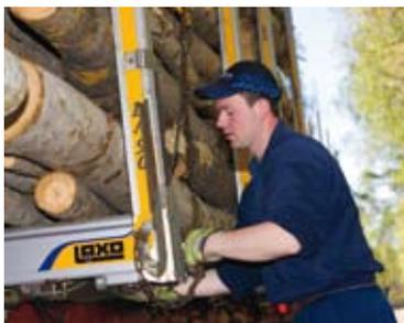
**2.** Der durchdachte Kettenhaken erspart Ihnen, die Kette umständlich über die Holzstämmen zu werfen. Mit dem Holzgreifer heben Sie sie ganz bequem über die Ladung. Die Gefahr von Verschleißschäden an Schultern und Rücken wird dadurch verringert und man spart Zeit.
